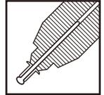
**6** ブラインドリベットのボディ(フランジ)を下穴に挿入します。
