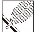
**7** リベッターの先端を母材に軽く押し当て、母材等にすきまがないことを確認した後、トリガーを引きます。
